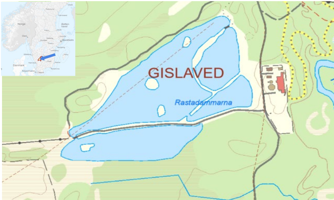
Figur 2. Rastadammene befinner seg i Gislaved kommune i Jönköpings län, Sverige. Systemet består av fire dammer som etter tur tar imot vann fra det lokale renseanlegget i øst (rødt). Etter å ha blitt renset gjennom fire dammer går vannet ut fra den sydligste dammen i øst og ut i elven Nissan, som kan skimtes i øst på kartet.
