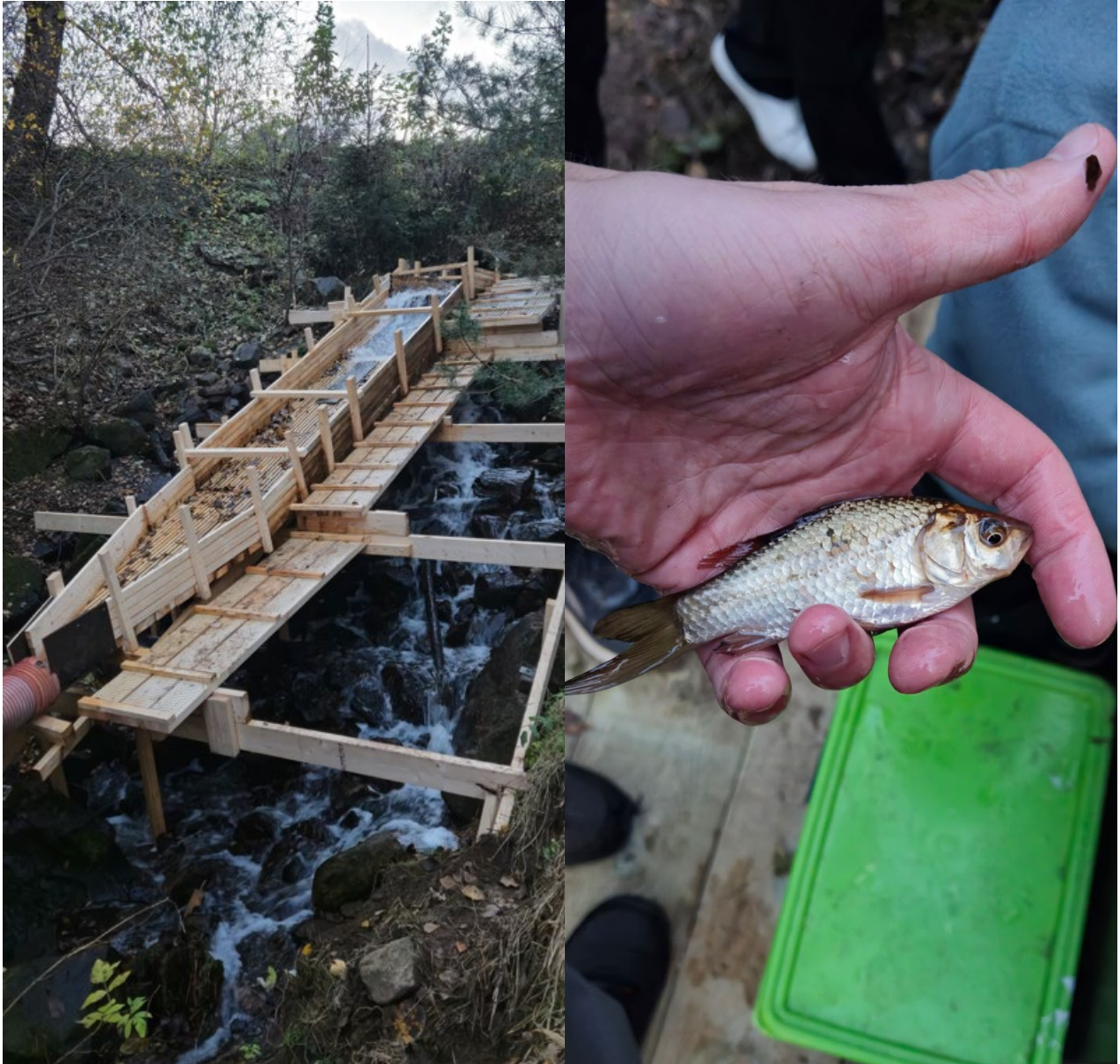
Figur 6. Venstre: En fiskefelle i utløpet av rensedammene sørget for at all fisk over en viss størrelse ble fanget opp og sendt inn i en oppsamlingskasse lenger ned (i enden av det røde røret). Høyre: En av fem gullfisk fanget i fiskefellen i helga før hydrologisk befaring i 2024. Foto: Øystein Nordeide Kielland/Veterinærinstituttet.
