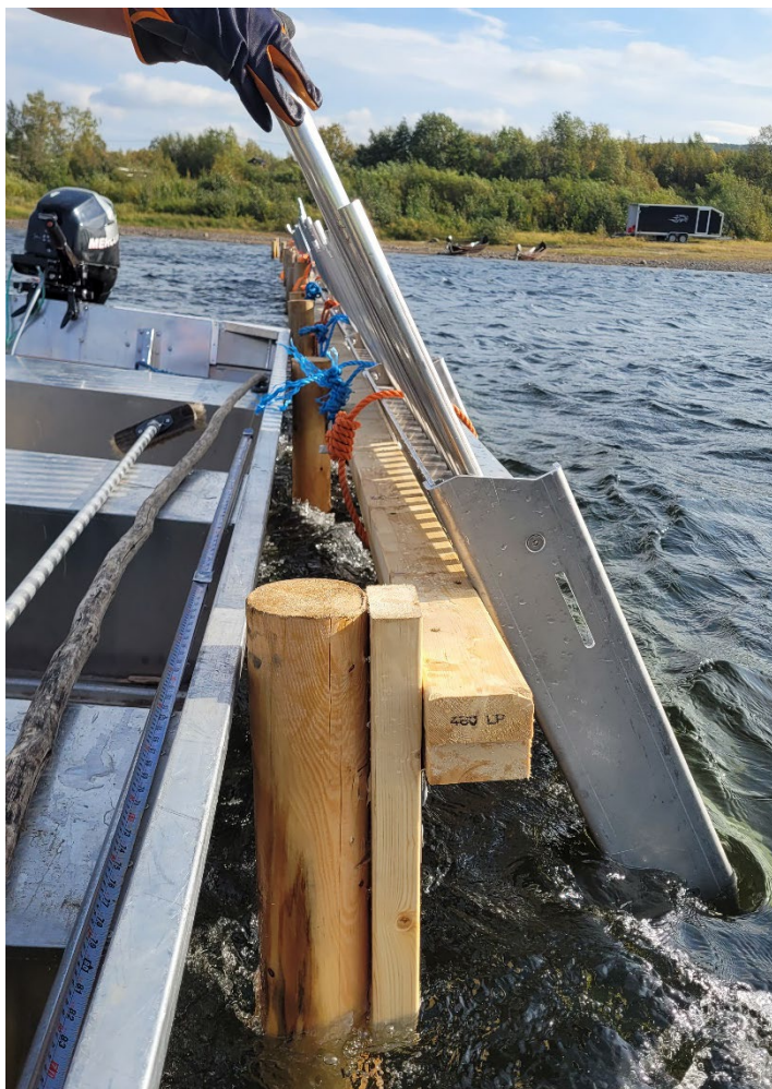
Figur 10: Siktebilde langs testriggen ved Seida i 2024. Bildene viser aluminiumsristene montert med anlegg moten langsgående tverrligger som er festet på trestolper slått ned i elvebunnen.
