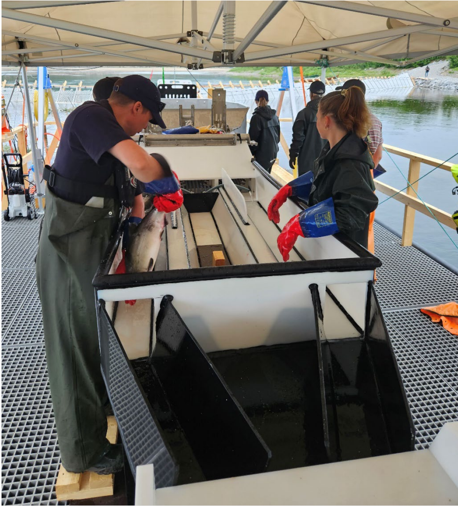
Figur 11. Sorteringsbord mellom ensretter og el-bedøver. Foto: Roar Sandodden
