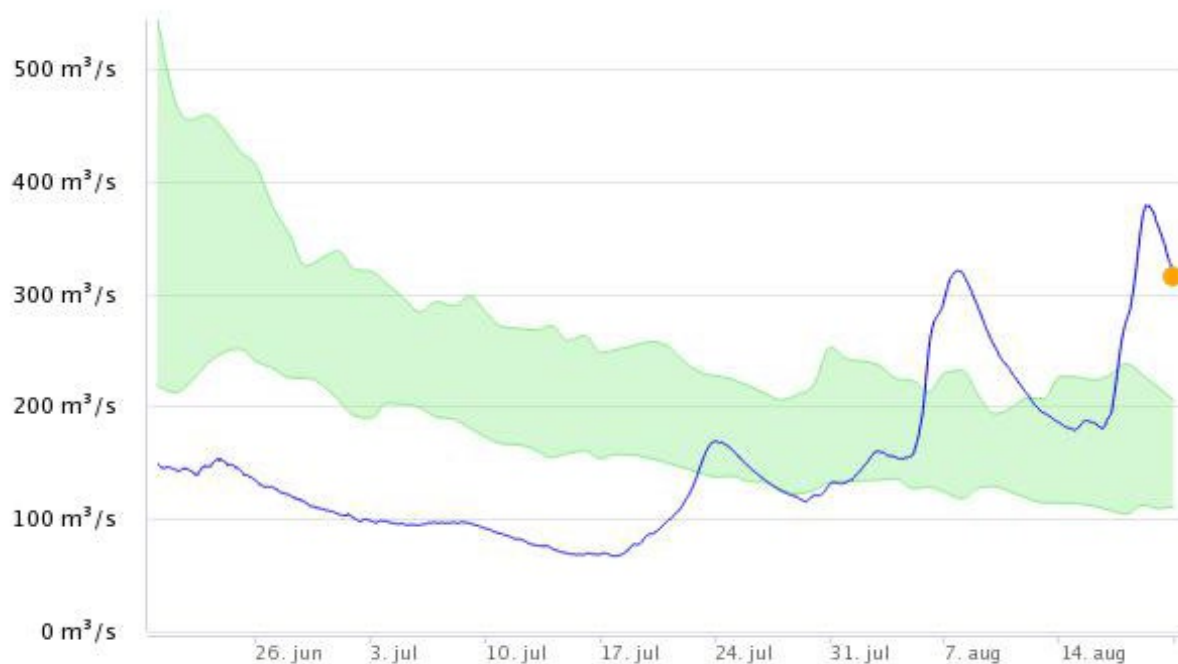
Figur 5. Vannføring på stasjonen Polmak nye fra 20. juni til 20. august 2023, markert med blå kurve. Halvparten av alle historiske vannføringsmålinger, 25 - 75 persentilen, er markert i grønt. Kilde: Norges vassdrag- og energidirektorat
