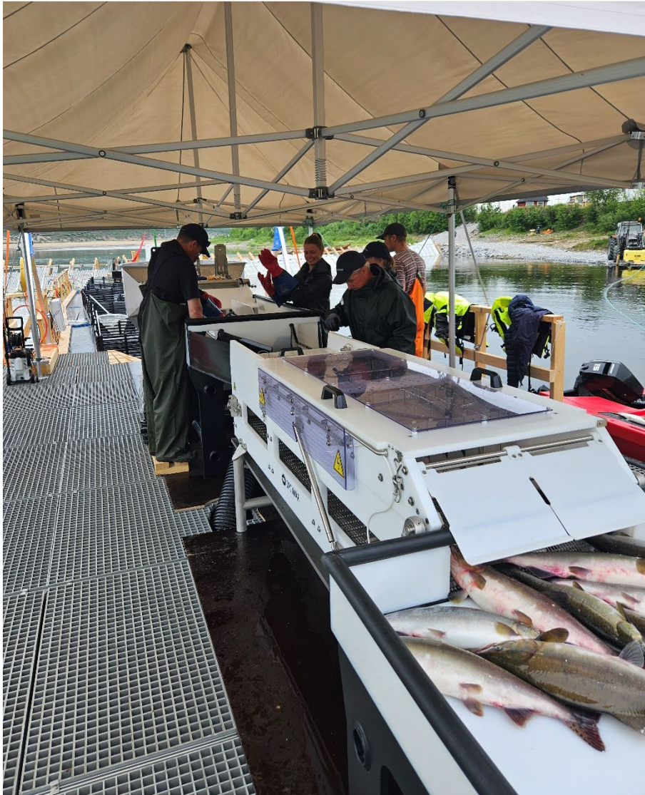
Figur 12. El-bedøver mellom sorteringsbord og bløggbord, her under slakteprosessen. Foto: Roar Sandodden
