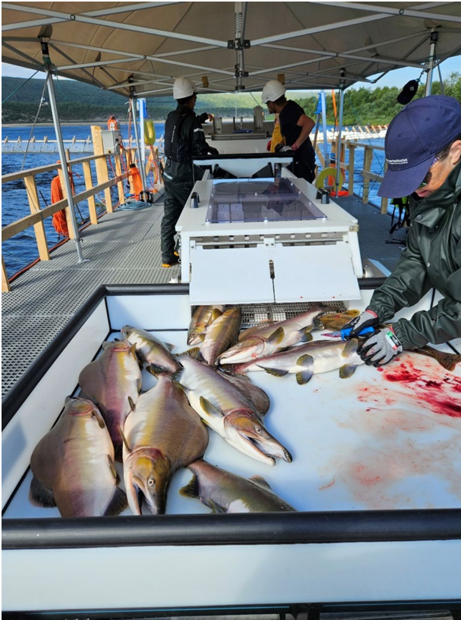
Figur 13. El-bedøver (stunner) og bløggebord i drift. Foto: Roar Sandodden
