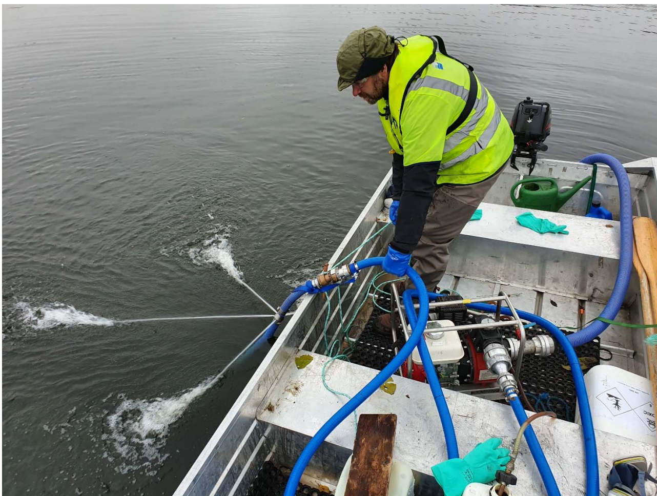
Figur 4. Dypdoseringslange benyttet i Hallumtjern. Funksjonstest før senking til doseringsdyp. Vannblandet rotenonløsning pumpes ut under trykk gjennom tre sprededysen lik den som vises over vannflaten.
