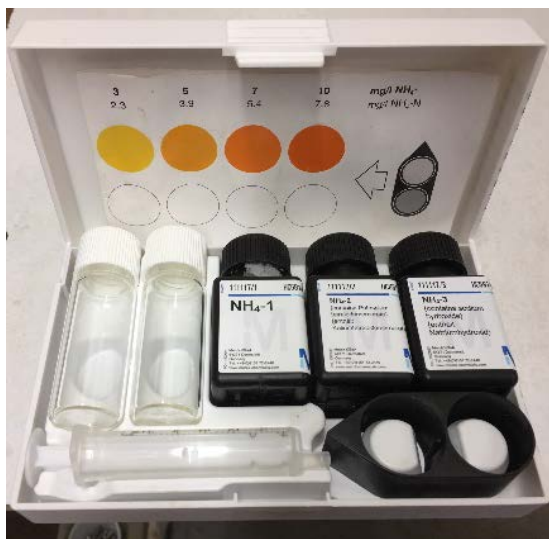
Figur 22. En type kit for måling av ammonium
