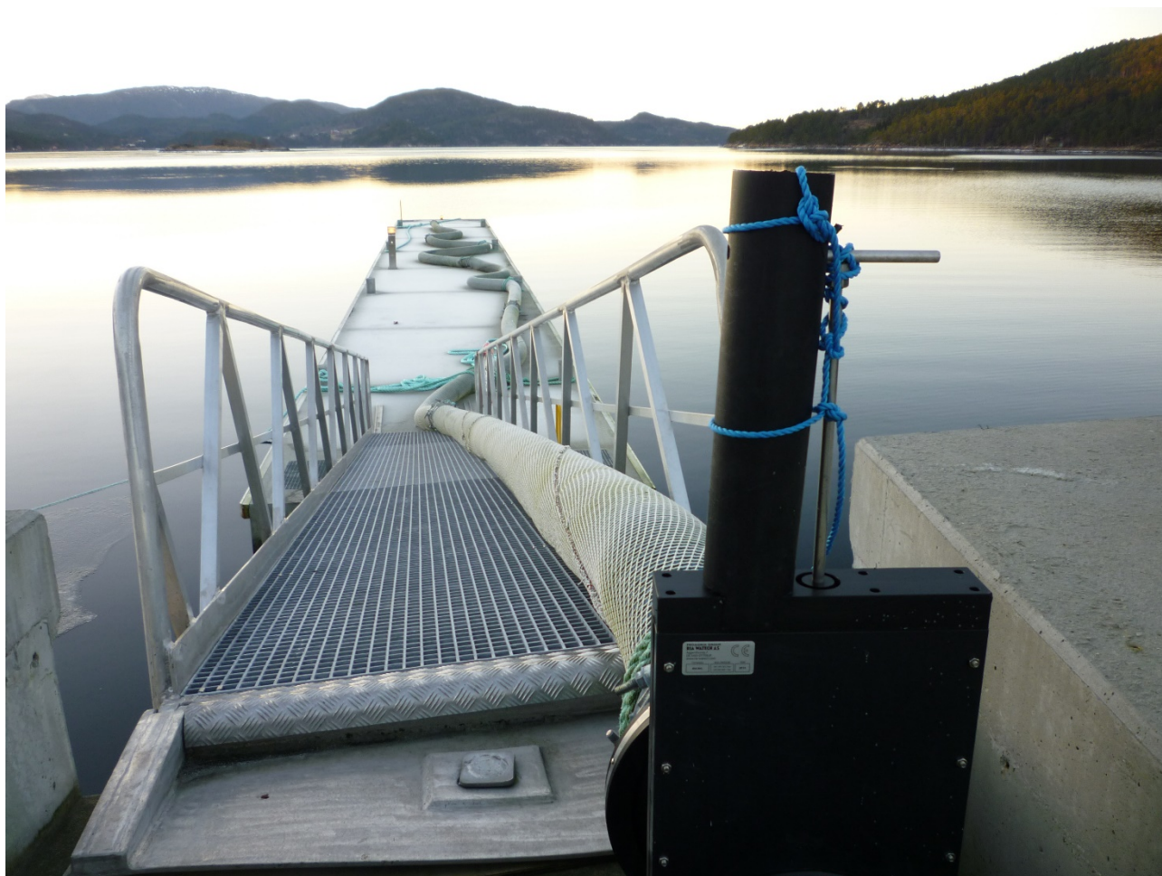
Figur 48. Transportslange for lasting av smolt om bord i brønnbåten.
