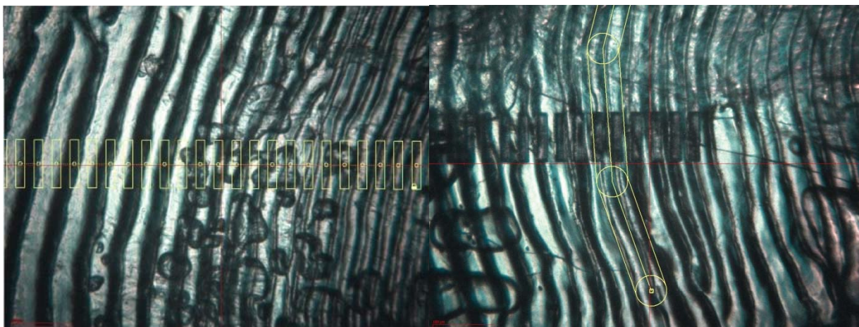
Figur 1. Skjermbilde av tegnede laserablaseringsbaner. Bildet til venstre viser punktablasering utover på skjellet (gule firkanter), mens bildet til høyre viser linjeablasering langs sklerittene (gule linjer).
