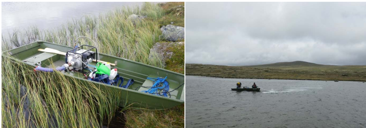
Figur 9. Aluminiumsgram med pumpeutstyr, en lett og stødig båt for doseringen av små tjern.
