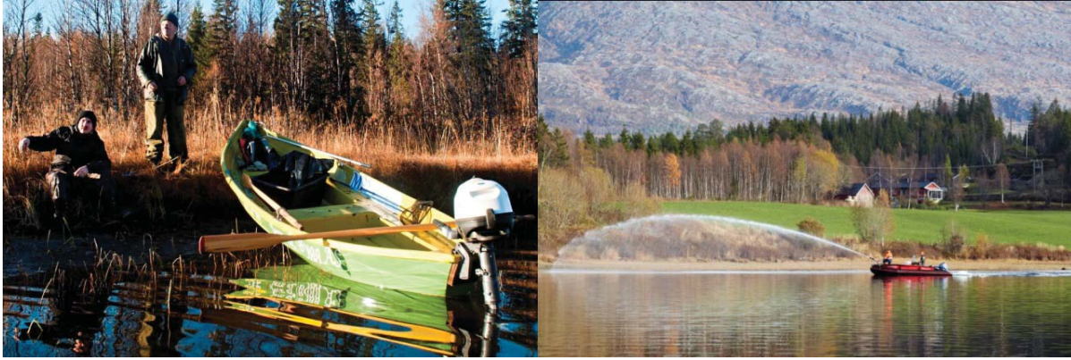
Figur 5.6. Paijan 471 med 5 hk påhengsmotor. Letthåndterlig båt brukt av dødfiskmannskap i elv og innsjø, og også tatt i bruk til breddebehandling i innsjøene. Her fra pause i dødfiskinnsamling under innsjøbehandling. Foto: Lena Knutli. Polarcirkel med 115 hk motor (til høyre). Båt med stor lastekapasitet og rekkevidde. Utstyrt med kraftig brannsprøyteutstyr. Her fra breddebehandling av Fustvatnet oktober 2012. Foto Dag H. Karlsen.
