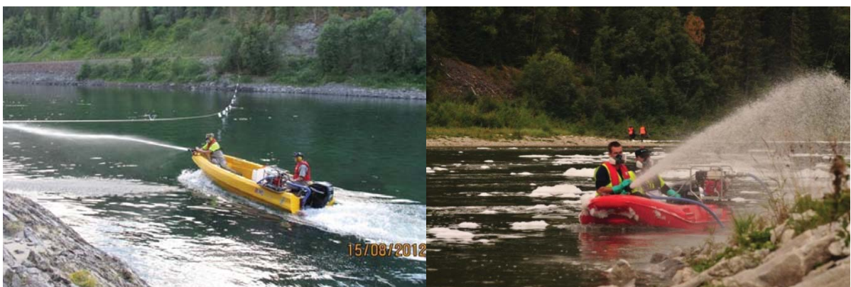
Figur 5.5. River 420 med 25hk motor, vannjet (til venstre). Primært til bruk på grunnere og striere deler av Vefsna. Stødig og stor bærekapasitet. Vannjet viktig for manøvrering i grunne partier. Her på oversiden av Forsjordfossen, Vefsna i 2012. River 350 med 15 hk motor (til høyre). Primært brukt på de øvre dypere deler av Vefsna, Laksfors til Fallan. Her ved Laksfors i 2011.
