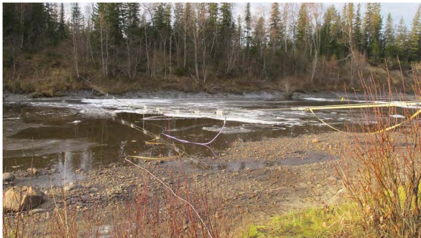
Figur 7.33. Problemer med isdannelse og gjenfrosne dyser ved hoveddoseringsstasjonen nederst i Herringelva på dag 3.
