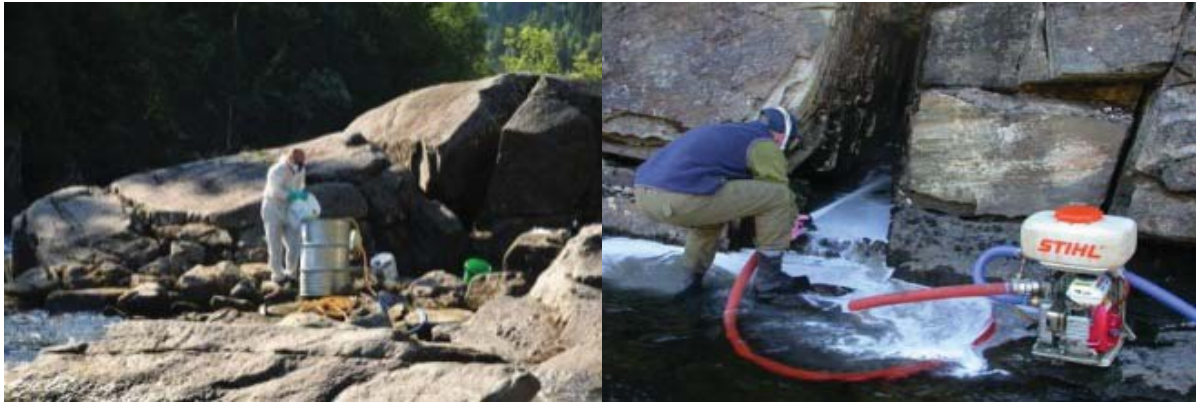
Figur 5.3. Hoveddosering fra fat, også kalt liten doseringsstasjon (til venstre). Ble brukt i middels store elver. Her fra hoveddosering i Fusta, august 2011. Bærbar pumpe (til høyre). Til bruk ved pumpebehov der det er vanskelig tilgjengelig for båt. Flere varianter finnes. Fra Halsanelva, 2003.
