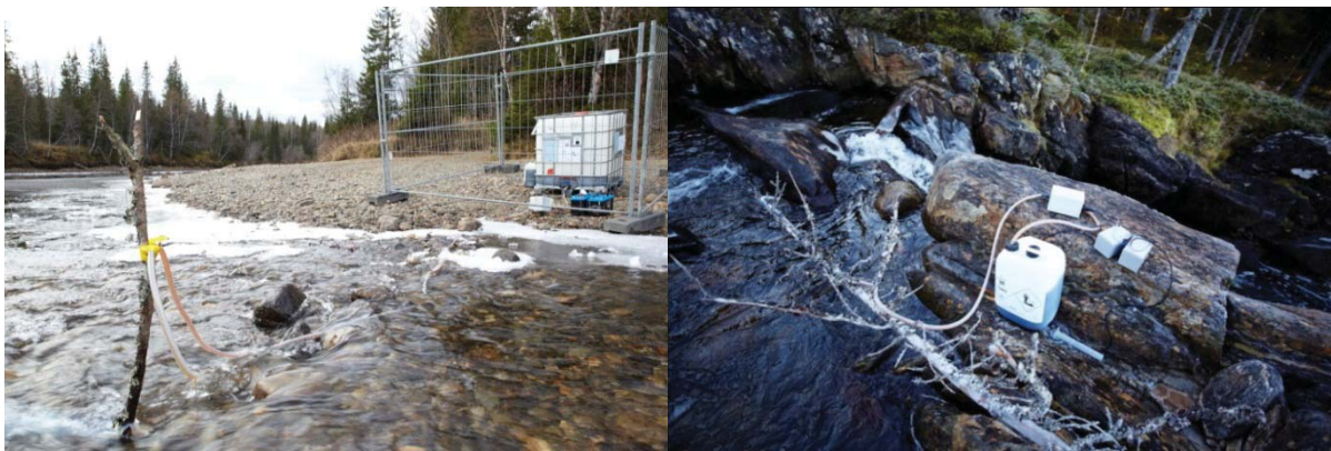
Figur 5.8. Dosering av ren CFT-L med Watson Marlow 300-serie peristaltpumpe i Herringelva (til venstre), og i innløpsbekk til Mjøvatnet (til høyre), oktober 2012. Foto: Dag H. Karlsen.
