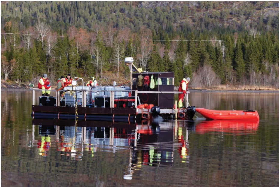
Figur 5.10 Dypdoseringsflåte, 12 x 6 meter (øverst). Foto: Lena Knutli. Dypdoseringsflåte, 8 x 4 meter (nederst). Foto: Dag Karlsen
