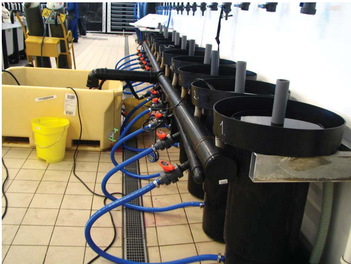
Figur 1. Storskala merking ved seriekobling av 30 liters klekkesylindere og bruk av ekspansjonskar med returpumpe og oksygentilsetning. Bilde fra produksjonsklekkeriet ved Genbanken for laks på Haukvik i Sør-Trøndelag (Foto Espen Holthe, Veterinærinstituttet).
