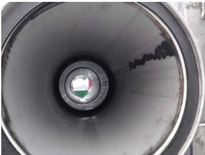
Figur 5: Utforming av ejektorpumpe - innside av rør / dysekammer (Foto: Arve Nilsen)
