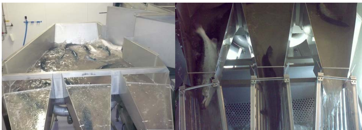
Figur 3. Bildet til venstre: Her ses laks idet den kommer inn i ensretteren (bak til høyre i bildet). Utgangene ses foran i bildet. Bildet til høyre viser detalj av fisk i utløpet (venstre og midtre utløp) og avsilingen er synlig i sporet til høyre. Foto: C. Mejdell og Kai Jensen
