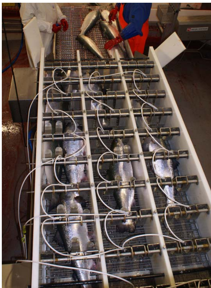
Figur 4. Bildet viser laks i elektrobedøveren og når den kommer ut på bløggbordet, etter bruk av ensretteren. All fisk er orientert samme vei. Foto: K. Gismervik
