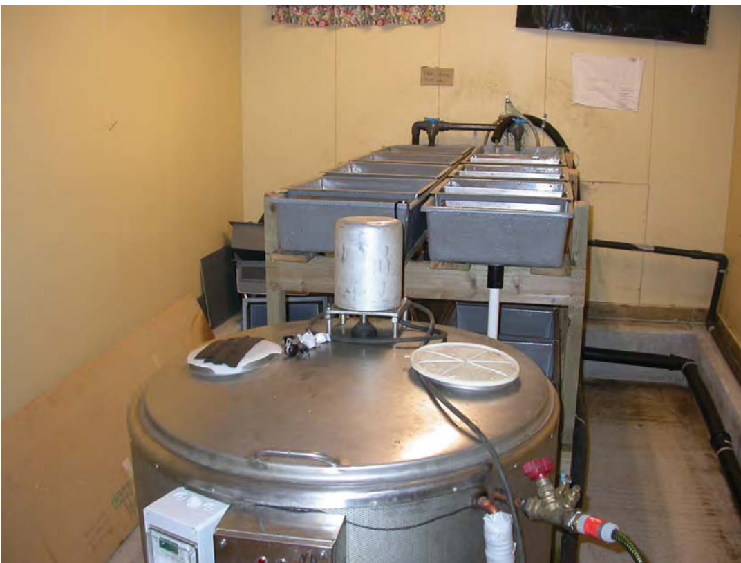
Bilde 1. Utsnitt av klekkeriet med klekkerrenner i bakgrunnen og kjøleenheten i forgrunnen.
