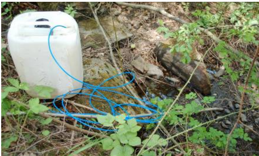
Bilde 2. Liten dryppstasjon med 8 meter utdoseringslange. Foto: Roar Sandodden.
