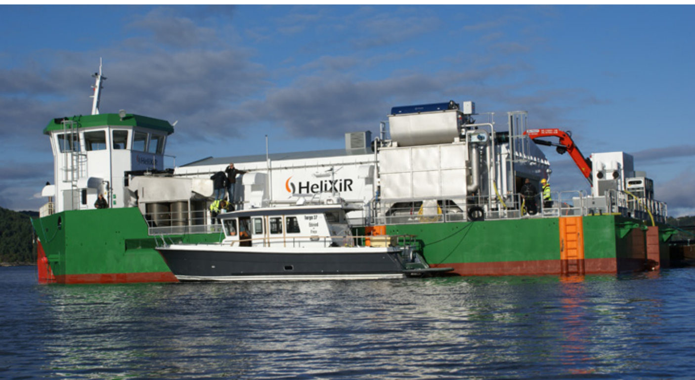
Uttesting av nyutviklet teknologi: Fiskehospitalet Helixir er utviklet for kontrollert badebehandling av luseinfisert laks.
