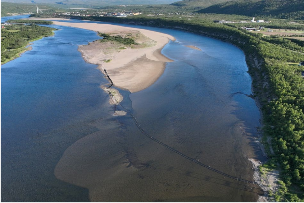
Figur 5.1. Oversiktsbilde (sett nedenfra og oppover elva) av ledegjerdet i det vestre løpet i Tanaelva forbi Seidaholmen. Fotograf: Joachim Henriksen.
